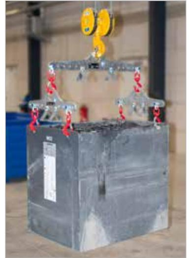
Kombination aus mehreren Traversen zur H-Traverse
